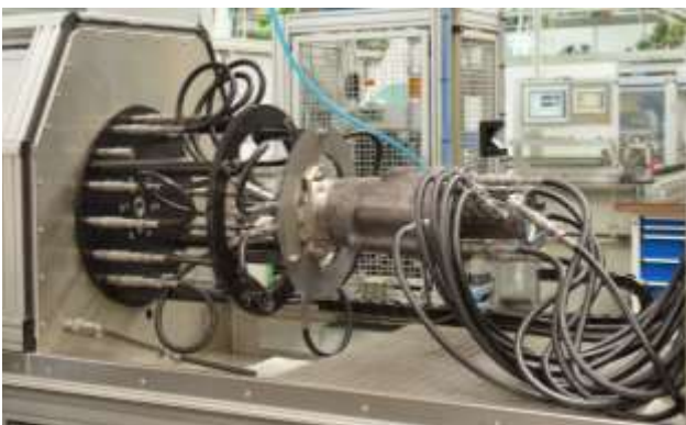
Abbildung 3: Die Drehdurchführungsprüfstände von Tries und eine hundertprozentige Produktprüfung garantieren die einwandfreie Funktionsfähigkeit beim Kunden
