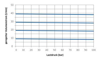
1 → 3 mit Lastdruck bei Anschluss 2
